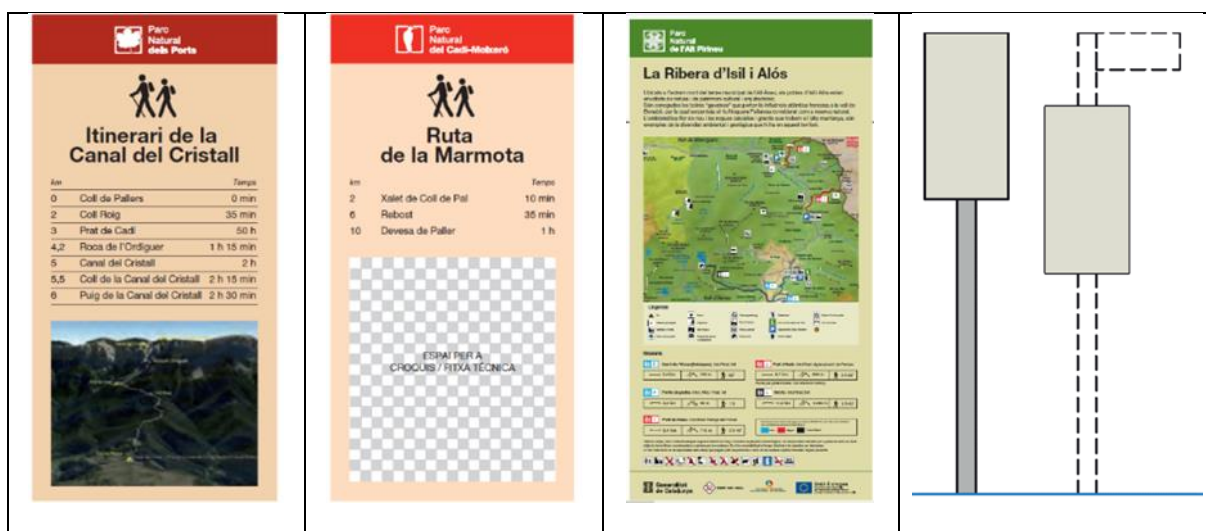
Figura 9 Exemple de senyals informatives de 450*900mm., i disposició sobre els suports de fusta. Font: Manual tècnic senyalització ENP
