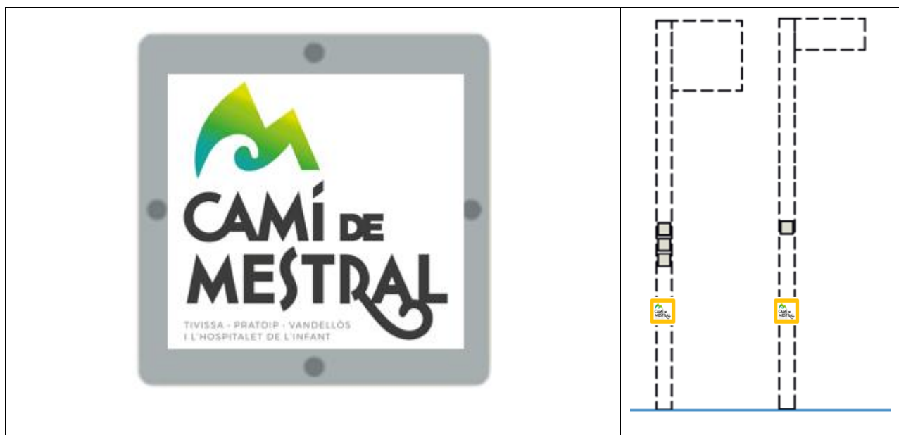
Figura 2 Exemple de plaques identificatives amb mascara de 80*80mm, i disposició sobre els suports de fusta. Font: Manual tècnic senyalització d'espais naturals protegits.
