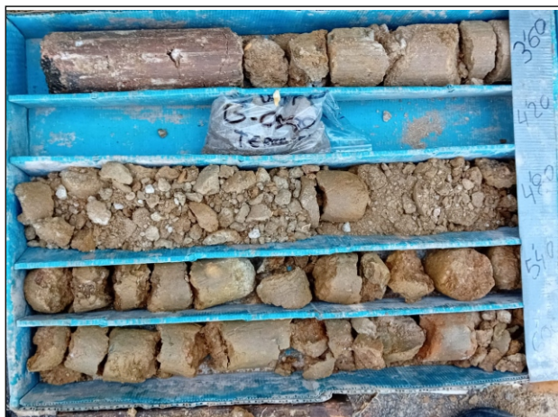
Fotografia 3: testigos y ensayos S1 (3,00-6,00 m)
