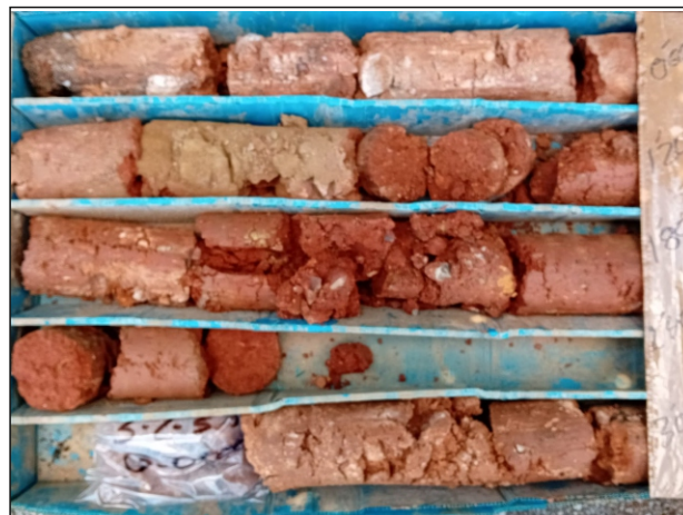
Fotografia 2: testigos y ensayos S1 (0,00-3,00 m).
