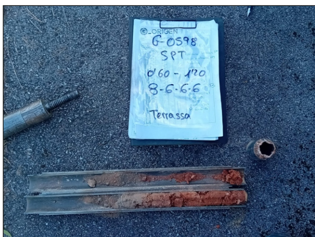
Fotografia 5: SPT-1, extraído entre 0,60-1,20 m de profundidad.
