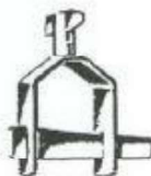
1 Brida con cuña para fijación de barandilla.
