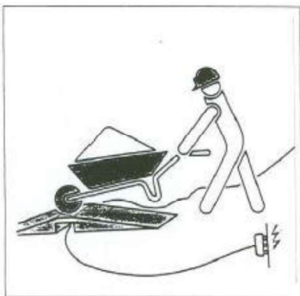
PROTECCION DE CABLES ELECTRICOS
