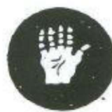
RIESGO DE CORROSION
