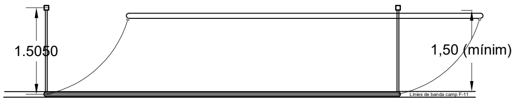
DETALL DEL MECANISME D'ANIVELLAMENT DEL BRAÇ TELESCÒPIC GIRATORI
