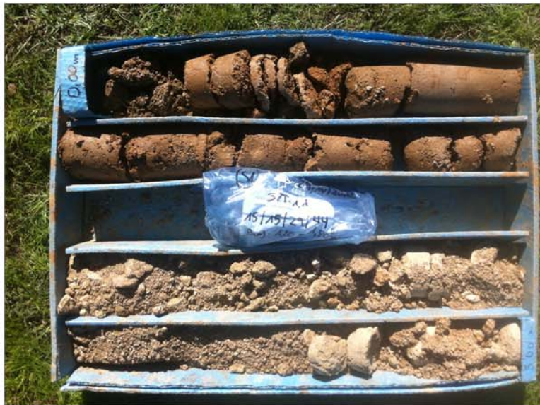
Foto 5: Material perforat entre 0 m i 3 m a S1.
