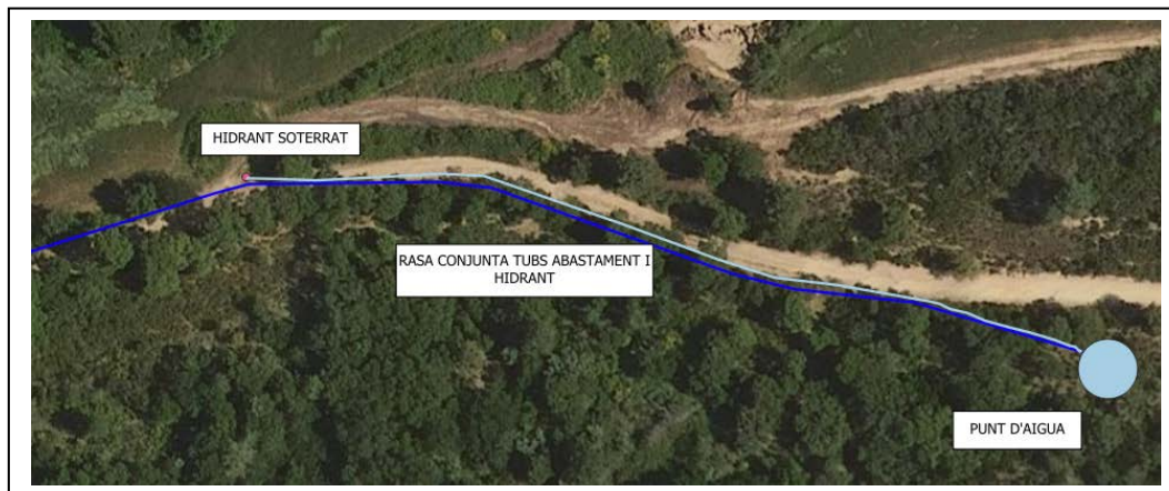
Imatge 28: Situació hidrant respecte al punt d'aigua
