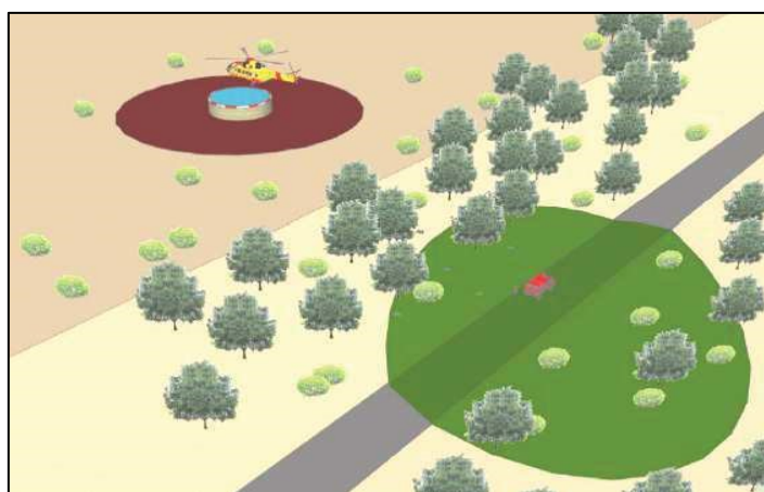
Imatge 13: Esquema de zona de protecció al voltant del punt de càrrega i al voltant del mateix punt d'aigua
