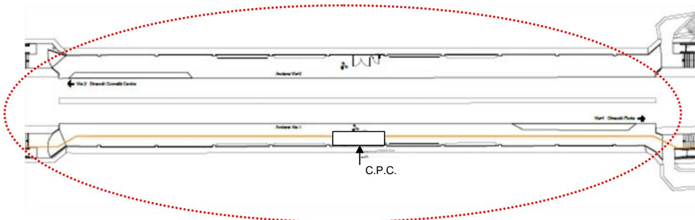
Esquema de la zona de andén con la Cámara Principal de Cableado (Cámara Auxiliar) y su ámbito de influencia. Las zonas límite entre dos cámaras auxiliares
