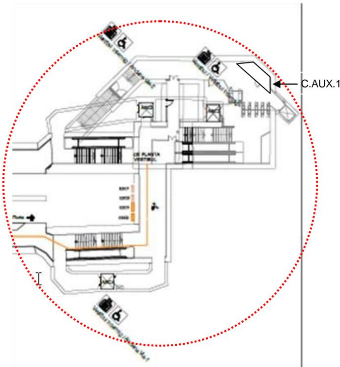
Esquema de la zona del vestíbulo principal con la Cámara Auxiliar 1 y su ámbito de influencia. Las zonas límite entre dos cámaras auxiliares, así como el recorrido de los cables dentro de la estación no dependen de su ubicación sino de la distancia al punto final y se determinará previa aprobación y acuerdo con el técnico de metro, que coordine la obra.
