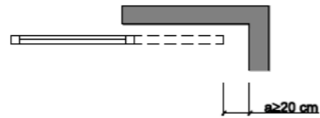
Figura 2.1 Holgura para evitar atrapamientos
