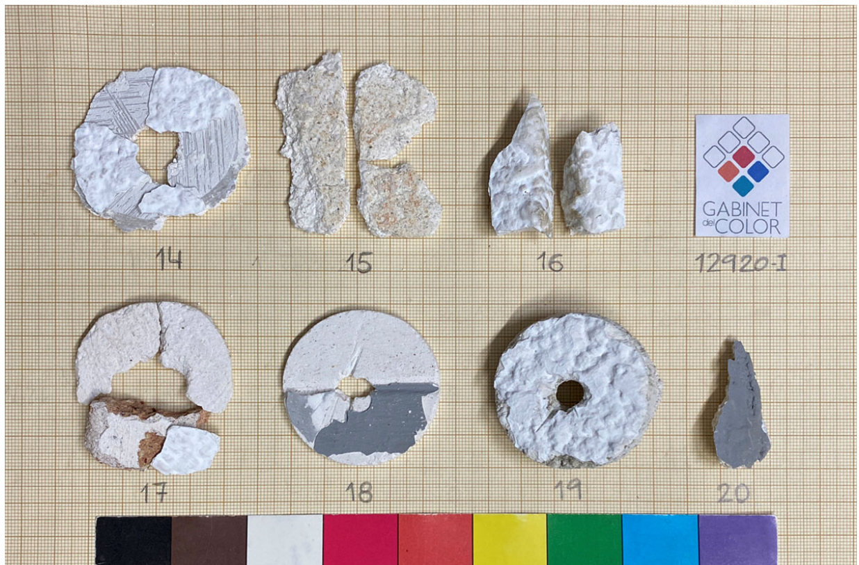
Mostres extretes als revestiments del vestíbul i a l'escala abans de la seva anàlisi microscòpica.
