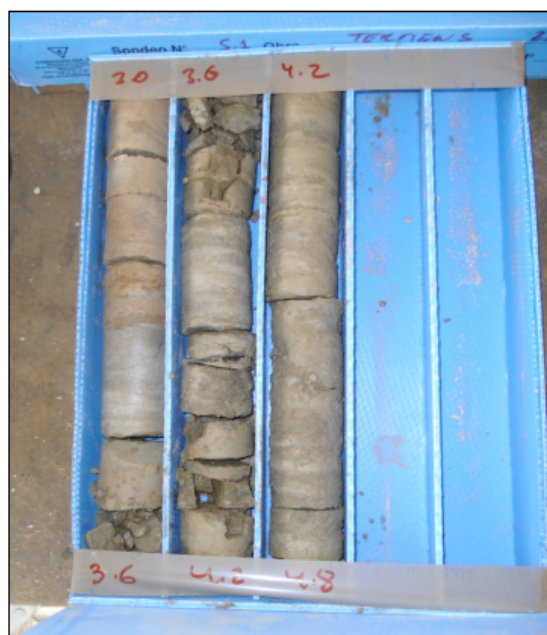
Caixa nº 2: Testimonis extrets del sondeig S-1 compresos entre 3,00 - 4,80 m de profunditat.
