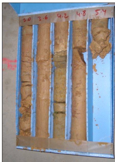
Caixa nº 2: Testimonis extrets del sondeig S-5 compresos entre 3,00 - 4,40 m de profunditat.
