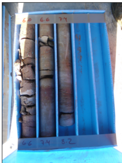
Caixa nº 3: Testimonis extrets del sondeig S-3 compresos entre 6,00 - 8,2 m de profunditat.
