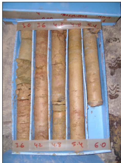
Caixa nº 2: Testimonis extrets del sondeig S-4 compresos entre 3,00 - 5,8 m de profunditat.
