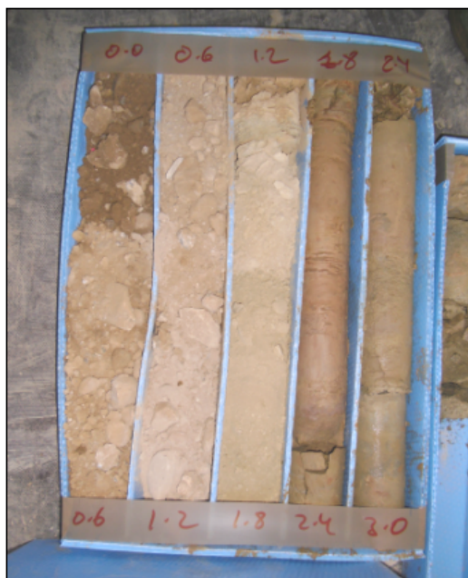
Caixa nº 1: Testimonis extrets del sondeig S-4 compresos entre 0,00 - 3,00 m de profunditat.
