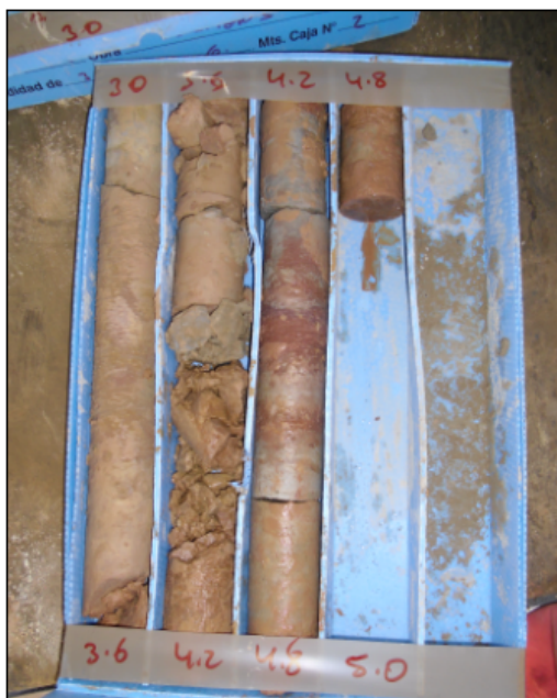
Caixa n o 2: Testimonis extrets del sondeig S-2 compresos entre 3,00 - 5,0 m de profunditat.
