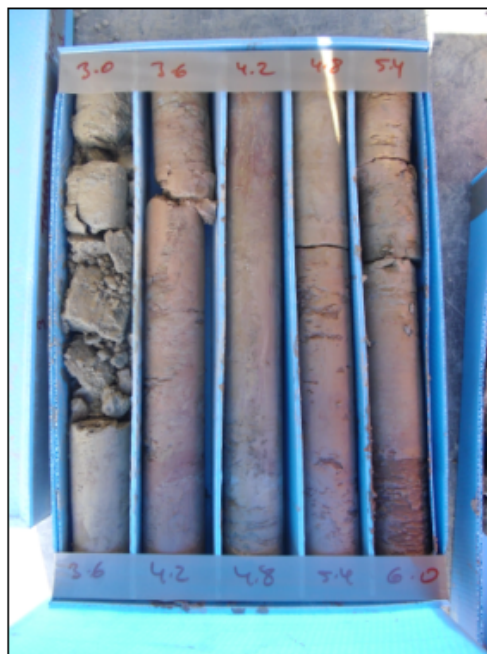
Caixa nº 2: Testimonis extrets del sondeig S-3 compresos entre 3,00 - 6,0 m de profunditat.
