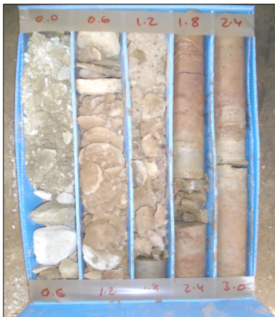
Caixa nº 1: Testimonis extrets del sondeig S-1 compresos entre 0,00 - 3,00 m de profunditat.
