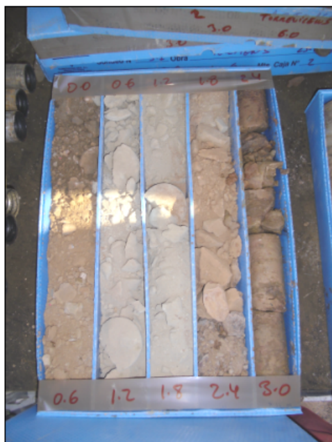
Caixa n o 1: Testimonis extrets del sondeig S-2 compresos entre 0,00 - 3,00 m de profunditat.
