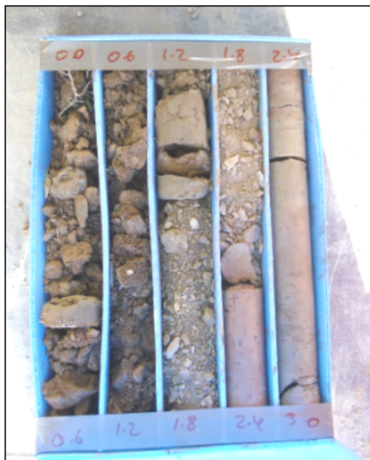
Caixa nº 1: Testimonis extrets del sondeig S-3 compresos entre 0,00 - 3,00 m de profunditat.
