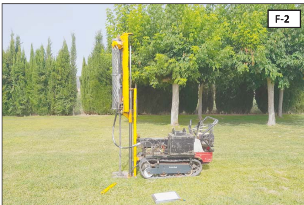
Fotografies 1 i 2: Detall de l'emplaçament de la màquina realitzant els assaigs de penetració dinàmica DPSH, P-1 i P-2, respectivament.
