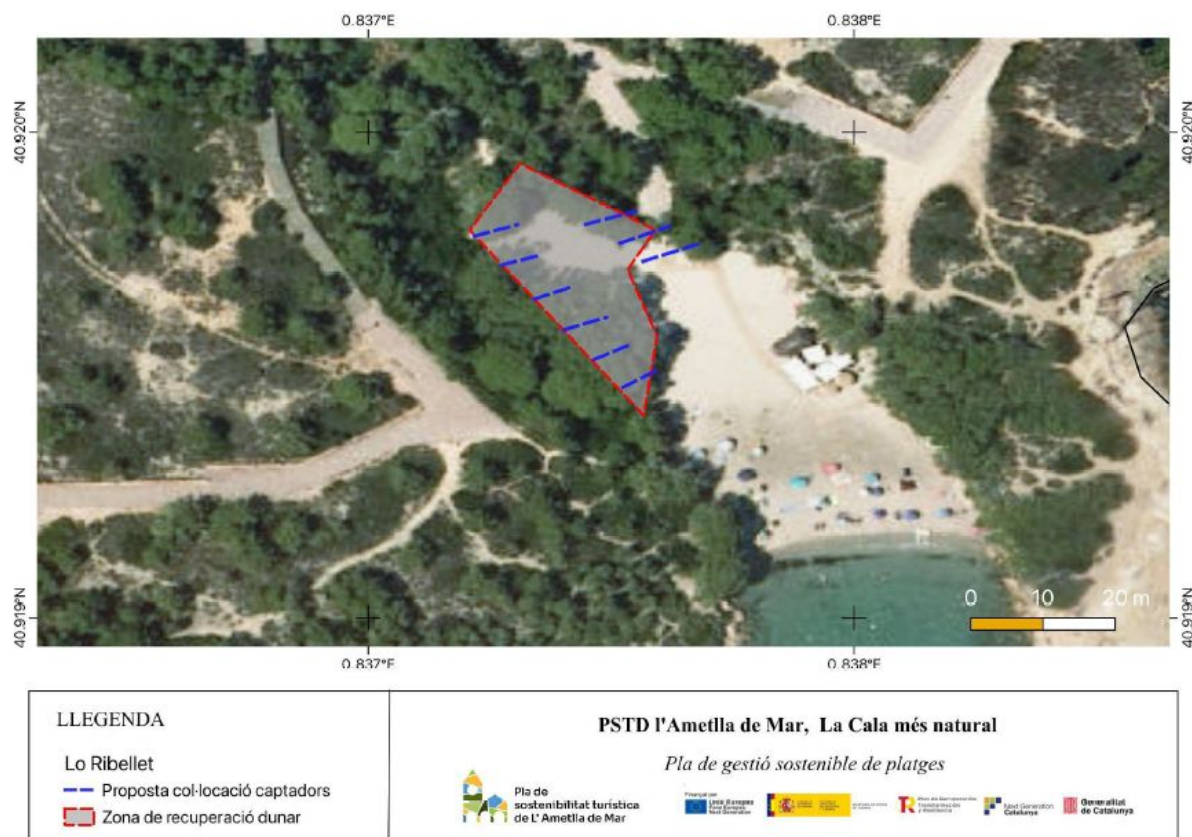
Figura 24. Proposta de tancament i posició dels captadors de sorra a la platja de Lo Ribellet. Elaborat sobre l'ortofoto del 2023 de l'ICGC.
