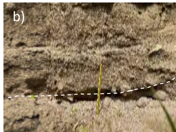
a) Escarpament erosiu que deixa al descobert un tall on es pot veure l'estratigrafia dels 50 cm més superficials d'un dels camps que conformen la plana al·luvial de la riera de la Pineda (T0'). b) Detall de la fotografia anterior, on s'aprecia a la base sediments de sorres fines a mitges amb un horitzó de grava i suprajacent a aquestes, sorres amb més percentatge de fins.
