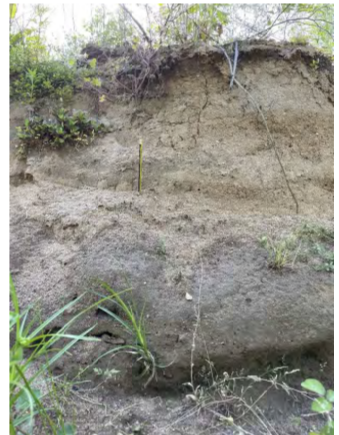
Fig. 15. L'escarpament deixa al descobert un tall on es pot apreciar els sediments predominantment lutítics de plana al·luvial formats per sorres fines amb alt percentatge d'argiles i llims.
