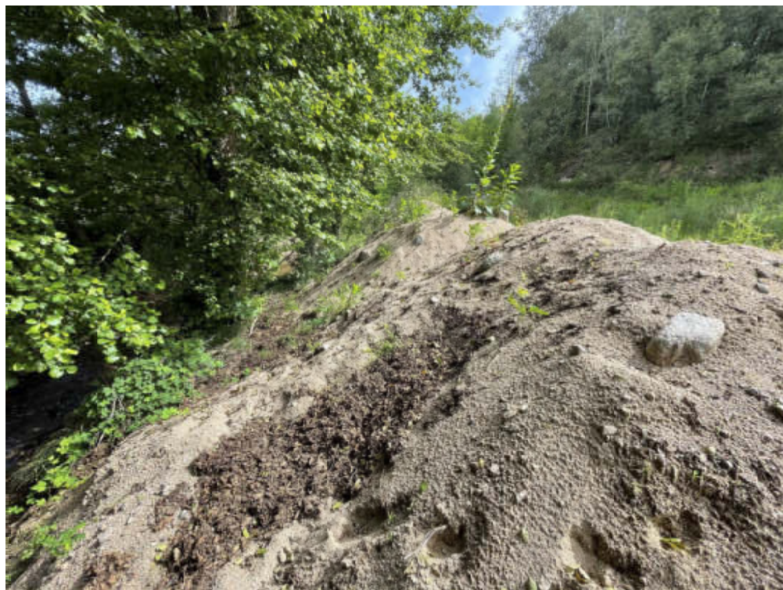
Fig. 10. Detall d'un dels monticles on es pot observar la seva composició, representada per sorres de granulometria mitja a grollera amb algun còdol de diàmetres predominantment centimètrics a puntualment decimètrics. La majoria d'aquests monticles presenten alçades que oscil·len entre 1 i 2 metres i amplades properes als 4 metres.
