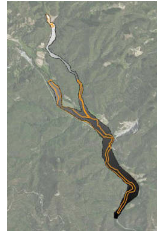
Figura 9. Model digital d'elevacions resultant de la zona d'estudi. En groc, àmbit de la topografia de detall.
