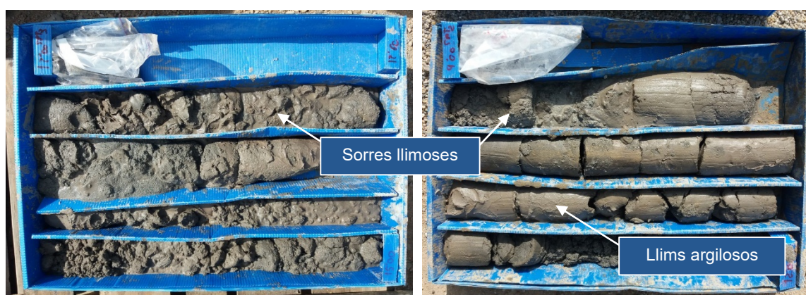
Figura 11. Aspecte que presenten els testimonis de la unitat de sorres.
