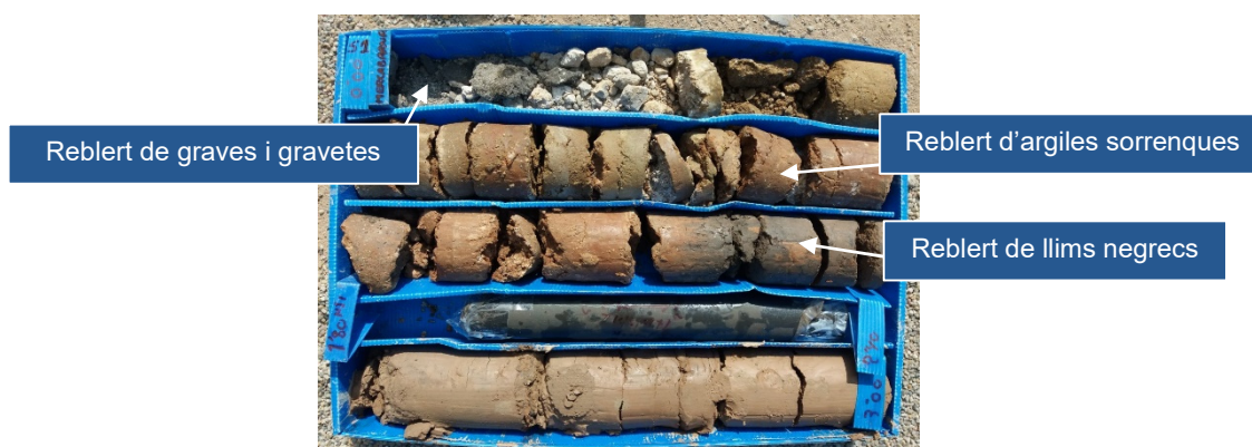
Figura 8. Aspecte que presenten els nivells de la unitat de reblert.
