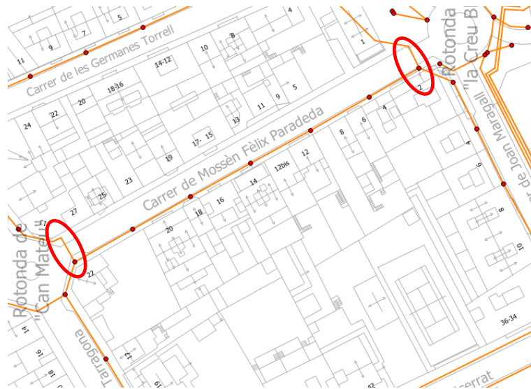
Figura 11. Serveis afectats: xarxa elèctrica enllumenat.
