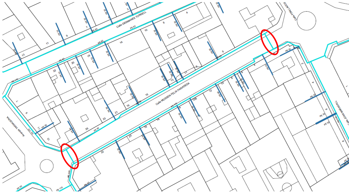
Figura 10. Serveis afectats: xarxa de gas.
