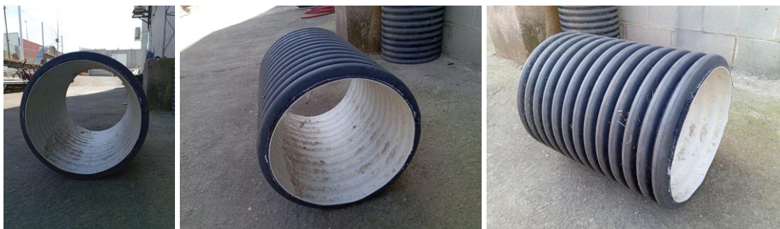
Figura 5. Tub PEAD tipus a instal·lar.
