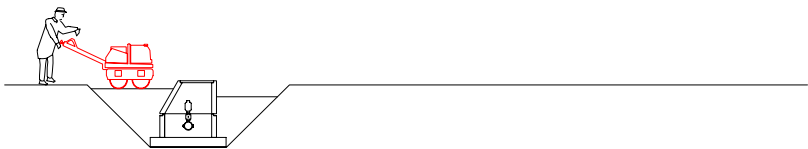
7. Compactació de terres al voltant del pou
