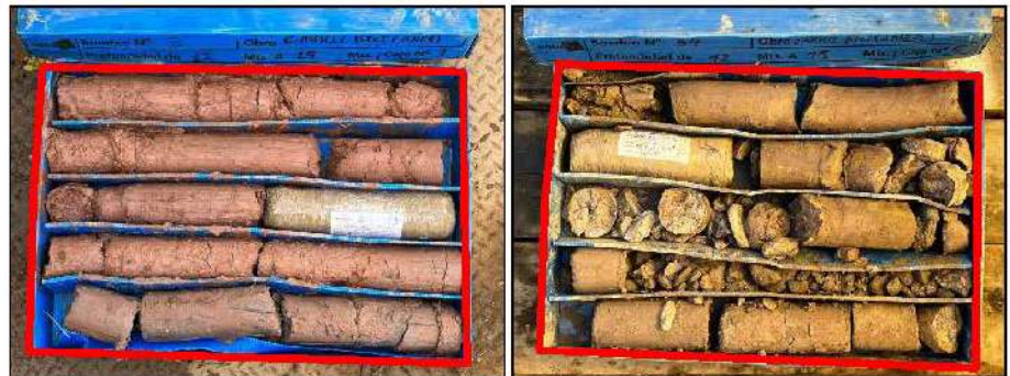
Figura 18. Detalle de los sondeos donde se observan los materiales pertenecientes a la unidad UG2.
