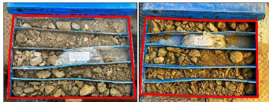
Figura 17. Detalle de los sondeos donde se observan los materiales pertenecientes a la unidad UG1.
