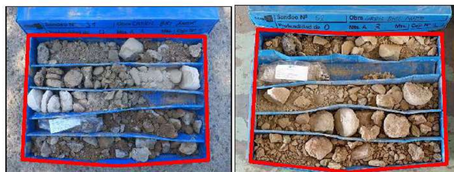
Figura 12. Detalle de los sondeos donde se observan los materiales pertenecientes a la unidad UG0.
