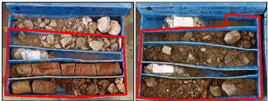
Figura 13. Detalle de los sondeos donde se observan los materiales pertenecientes a la unidad UG1.
