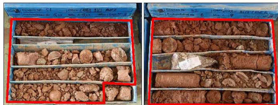
Figura 14. Detalle de los sondeos donde se observan los materiales pertenecientes a la unidad UG2.
