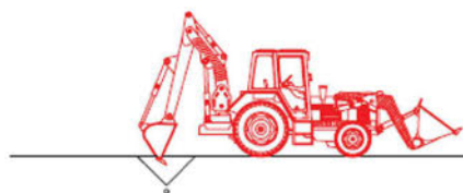
1. Buidat de terres amb retro-excavadora
