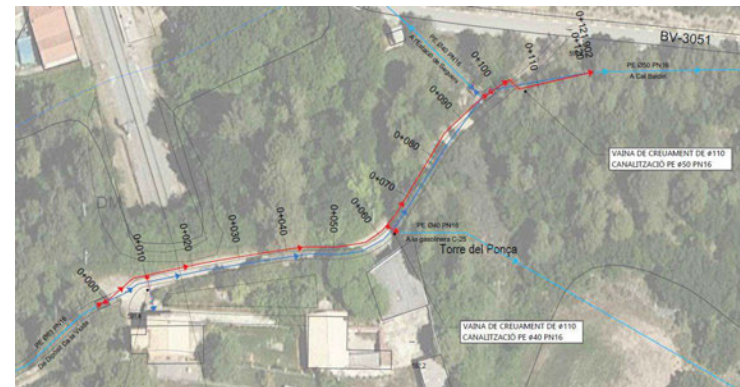
Figura 14. Tram de canalització a substituir
