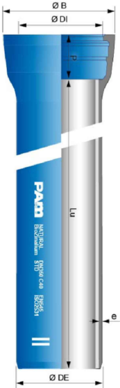
Tubería NATURAL BioZinalium® junta STD DN350-600
