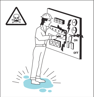
REPARACIÓ D'EQUIPS SOTA TENSIÓ
