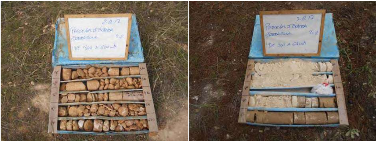
Fig. 11.-Vista de les calcarenites poc alterades i de les margues argiloses ocre verd del sondeig S-8 (dreta)
