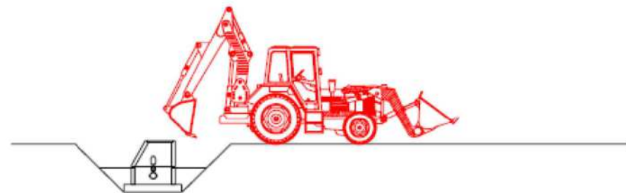
6. Reblert del pou amb retro-excavadora en tongades
