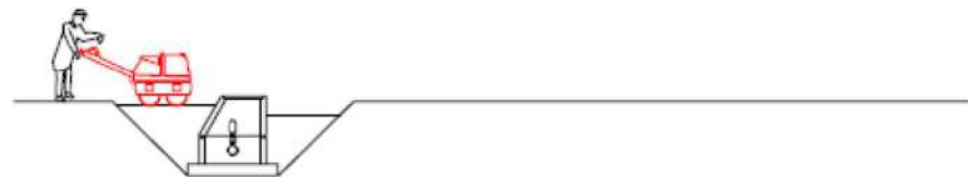
7. Compactació de terres al voltant del pou
