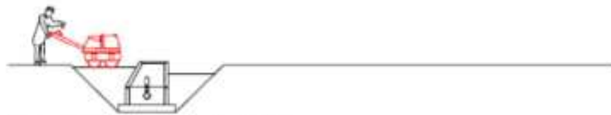
7. Compactació de terres al voltant del pou
