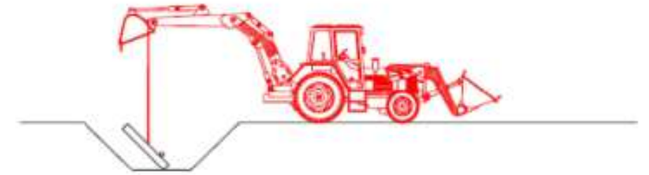
3. Col·locació de la base del pou
