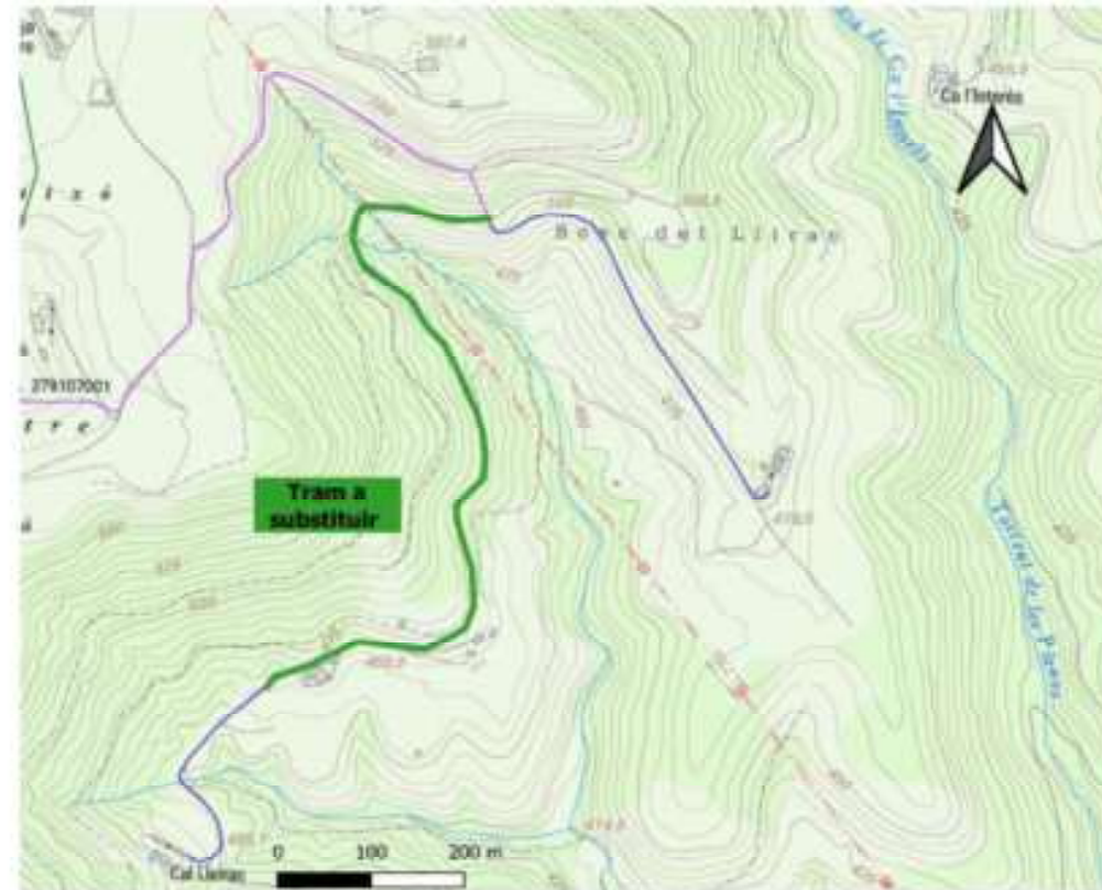
Figura 4: Proposta de tram de substitució de la xarxa d'abastament en baixa a la zona Urbanització i Fabrica Ca l'Agustí
