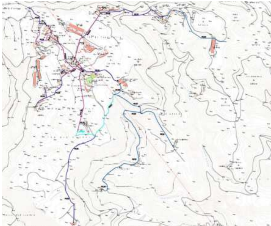
Figura 1. Traçat de la xarxa de distribució actual a Sant Mateu de Bages
