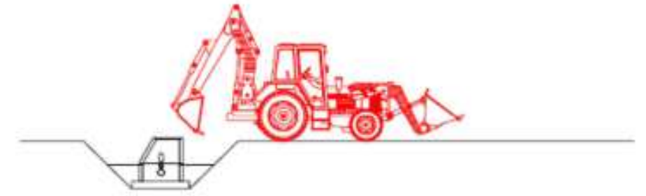
6. Reblert del pou amb retro-excavadora en tongades
