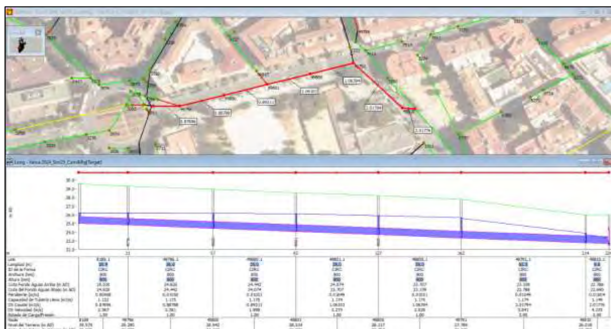
Figura 5. Perfil longitudinal del node 8189 al node 2718. Període de retorn T=10 anys.
