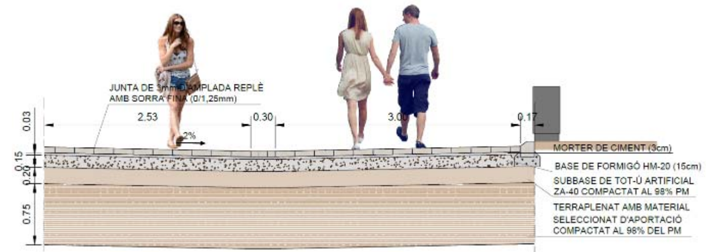
Figura 18. Secció transversal Vial Peatonal 2. Tram A.
