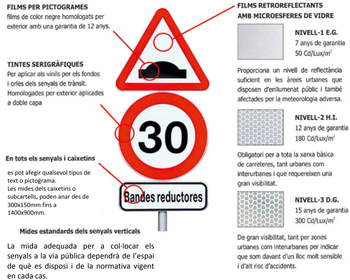
Figura 86. Característiques tipus senyals verticals part frontal.
