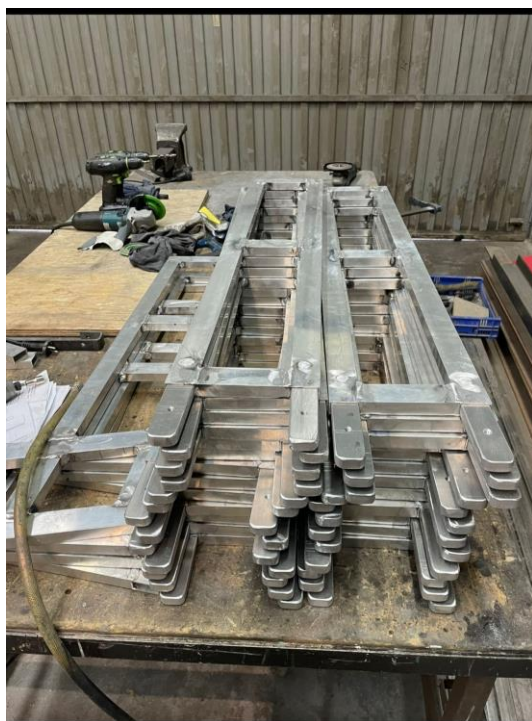
Marc del tul: estructura d'alumini.
