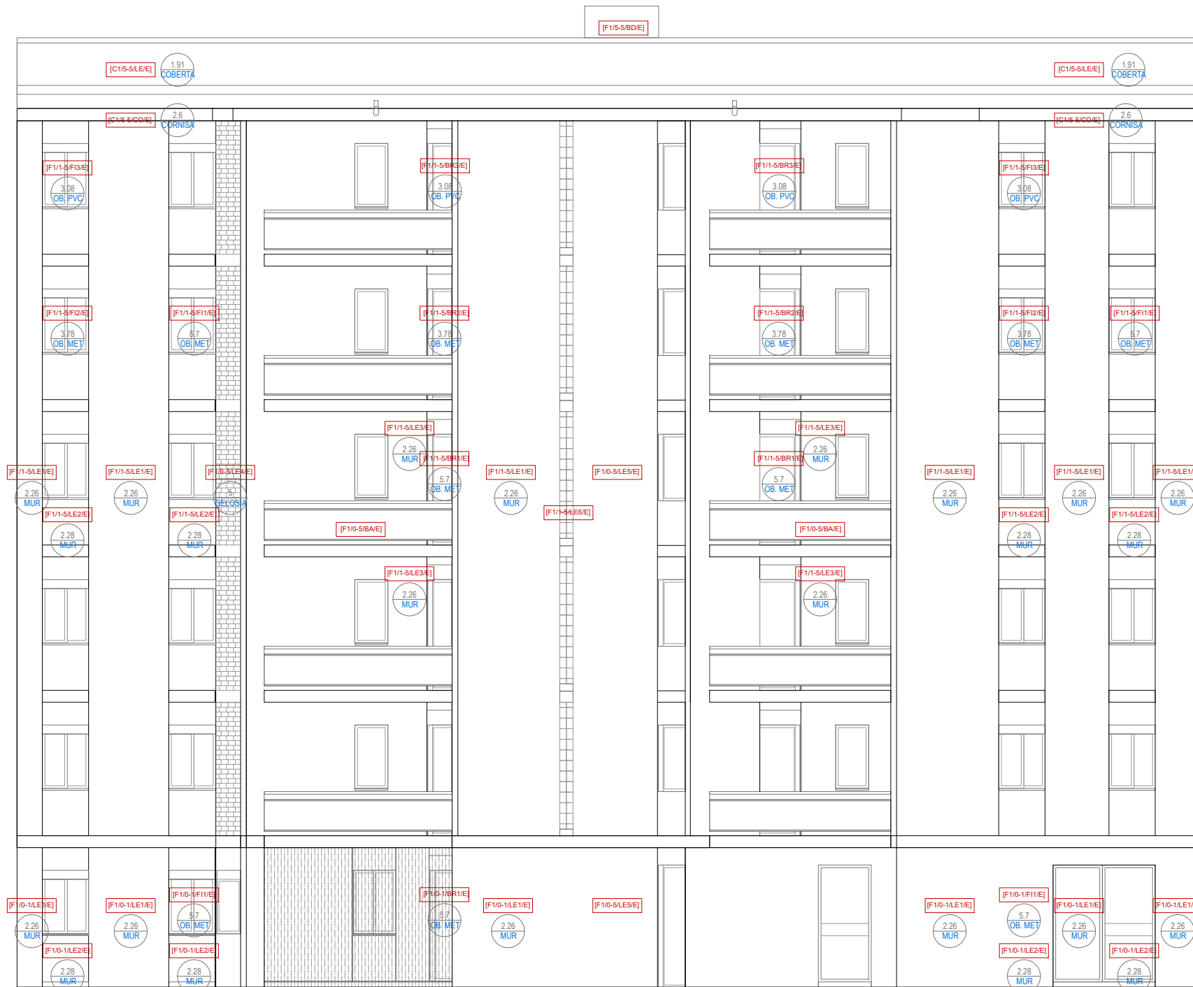
TANCAMENT FAÇANA TIPUS LE1 I LE3 1. Revetiment de guix 2. Bloc de formigó de 180mm 3. Morter de ciment 4. Pintura
