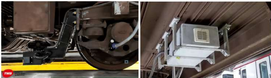
Imatges: Sistema vmRail instal·lat a L1 de TMB. Esquerra: dispositiu de percepció i dispositiu de mesurament de vibracions. Dreta: mòdul de control.
