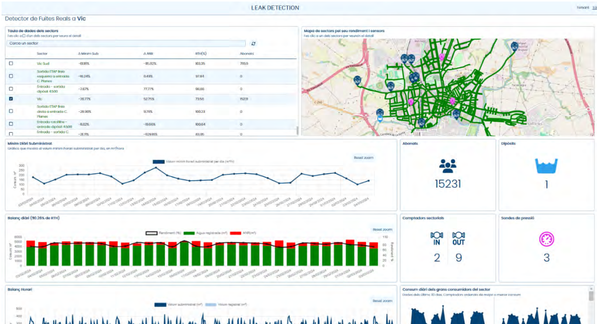
Figura 12. Dashboard de balanços hidràulics per sectors.
