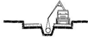
③ INSTAL·LACIÓ DE TUBS I FORMACIÓ DE PC REPL·I COMPACTACIÓ POSTERIOR CREUAMENT DE VIALS EMBORNALS I ESCOMESES CLAVEGUERAM
