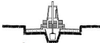
⑦ EXCAVACIÓ DE RASES I POUS ENTIBAT
