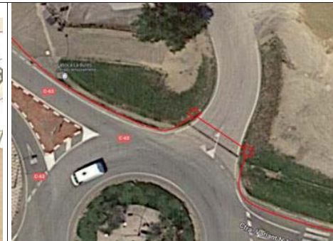
Girola de la cruïlla de la Ctra N-e i la Ctra C-63, amb el pericó tipus B2 17008PE2406+17008PE2407
