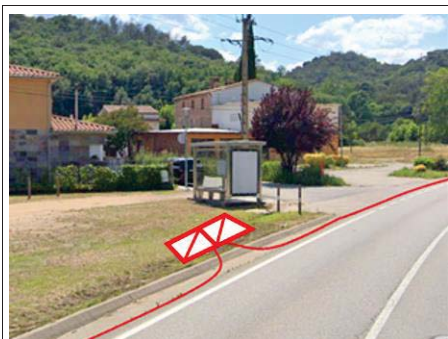
Micro-rasa tipologia ST2a, a la carretera N-141e PK 108+530, amb pericó tipus C2, al voral (17020PE2415) a la cruïlla amb el C/ Turó dels Cavalls, sortint amb tipologia ST-7
