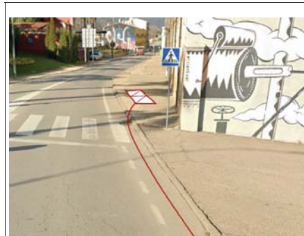
Micro-rasa tipologia ST-1, ampliarem el pericó 17008PE0020, del projecte d'estesa de Sta. Coloma de Farnés a Amer XT00124a a tipus C2 e instal·larem una CE
