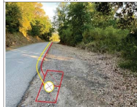
Final de la troncal a Vilanna, en la Caixa d'emplament 17020CE01PE2427 , al a la carretera de Vilanna PK 1+135
