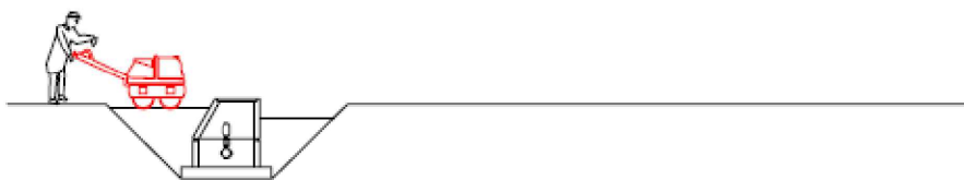
7. Compactació de terres al voltant del pou
