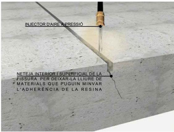
DETALL NETEJA INTERIOR FISSURA
