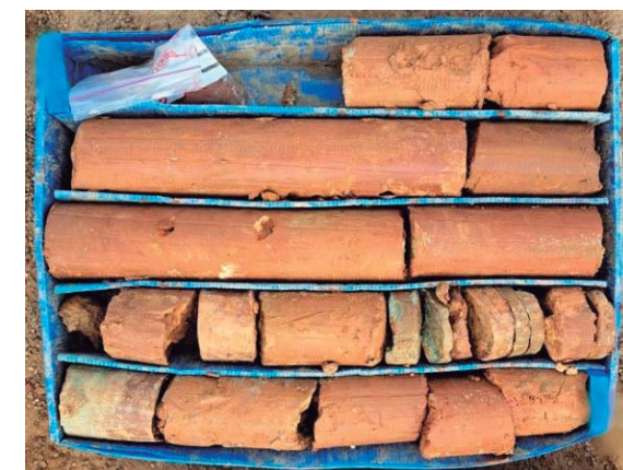
Figura 12. Aspecte que presenta el Substrat Terciari.
