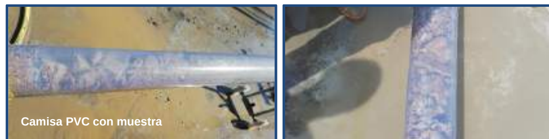
Fotografía 3. Tubo de acero que aloja el tubo de PVC que contiene la muestra.
