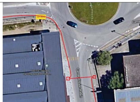
Micro-rasa tipologia ST8, creuament del C/ Isaac Rabin amb tipologia ST-7, i entrada a la carretera GI-535 amb tipologia ST-1, amb 2 pericons (C2 17155pe2413 i B2 17020pe2402)
