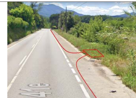
Micro-rasa tipologia ST2a, a la carretera N-141e PK 104+356, amb pericó tipus B2, a terres (17020PE2423)
