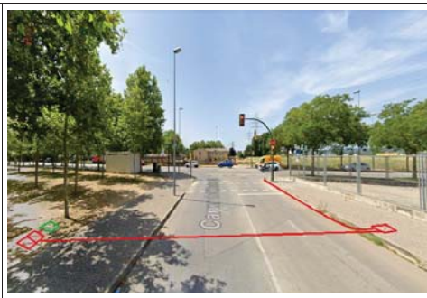
Micro-rasa tipologia ST7, pel creuament del C/ Montnegre fins el pericó 17155PE2417
