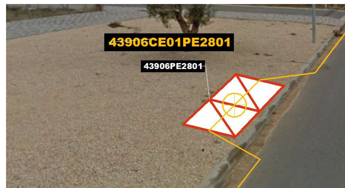
Fig 62 Ubicació caixa d'empalmament 43906CE01PE2801 en pericó 43906PE2801
