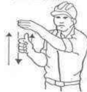
4 Levantar el aguilón o pluma lentamente.
