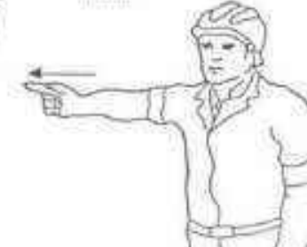
11 Girar el aguilón en la dirección indicada por el dedo.
