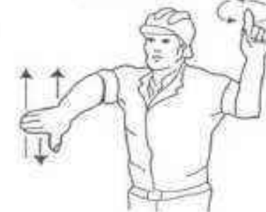
10 Bajar el aguilón o pluma y levantar la carga.
