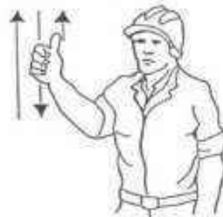
4 Levantar el aguilón o pluma lentamente.
