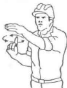
3 Levantar la carga lentamente
