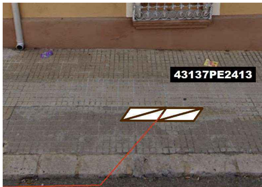
Fig 76: Ubicació pericó 43137PE2413 i microrasa 6c20
