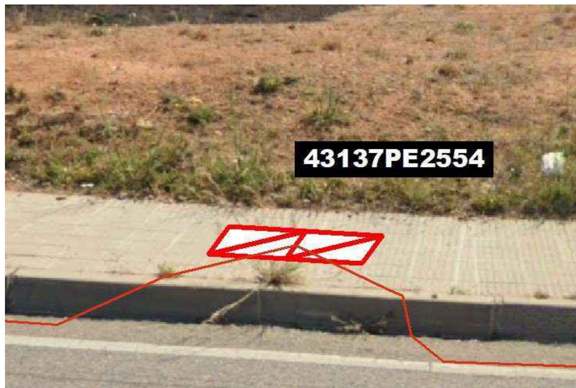
Fig 75: Ubicació pericó 43137PE2554 i microrasa 6c20
