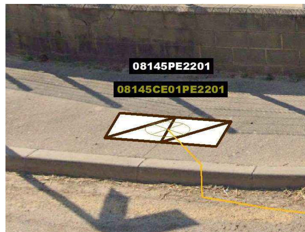
Fig 117: Ubicació caixa d'empalmament 08145CE01PE2201 en pericó projectada no executada 08145PE2201
