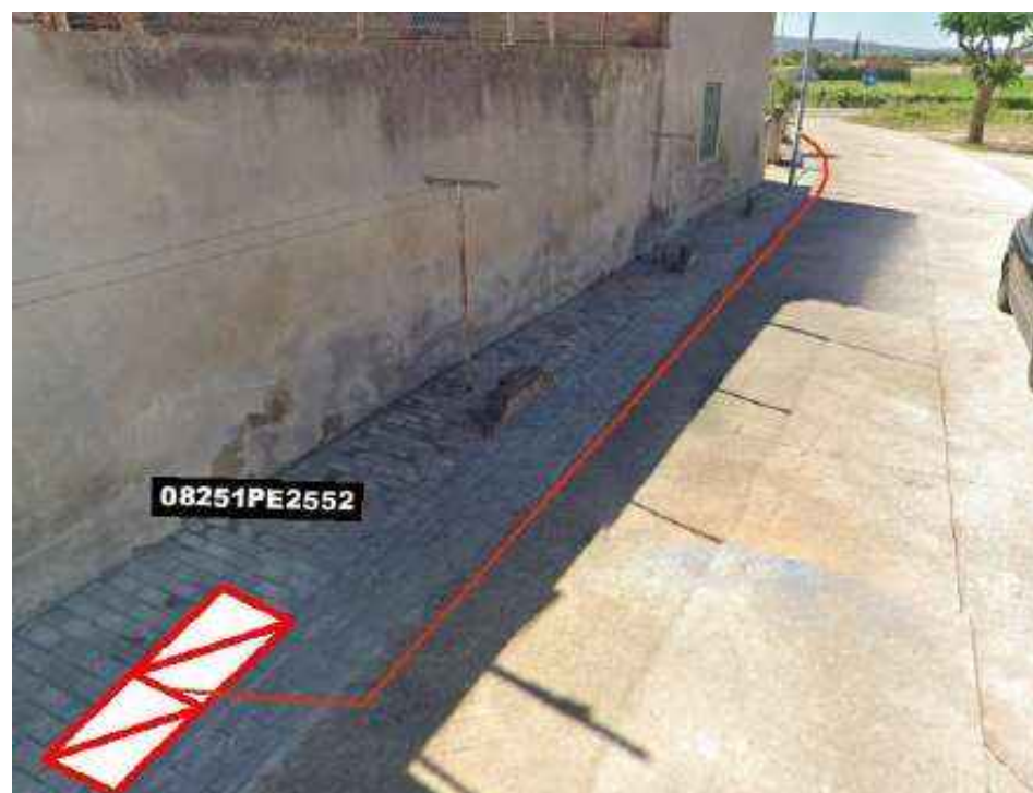
Fig 50: Ubicació pericó 08251PE2552 i microrasa 6c20.
