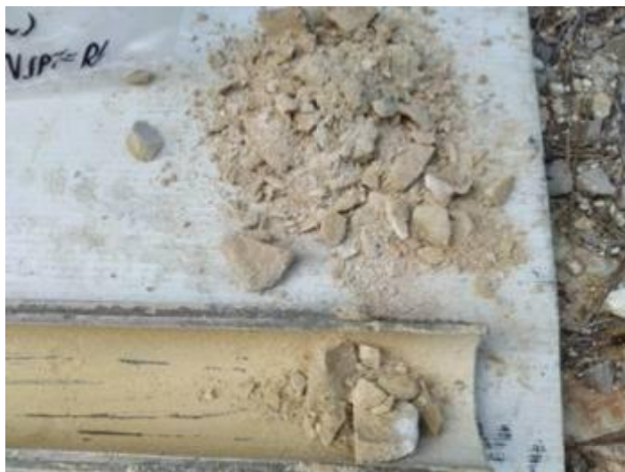
Vistes dels materials del subsòl extrets en un dels dos assaigs SPT realitzats al llarg del sondeig S-3.
