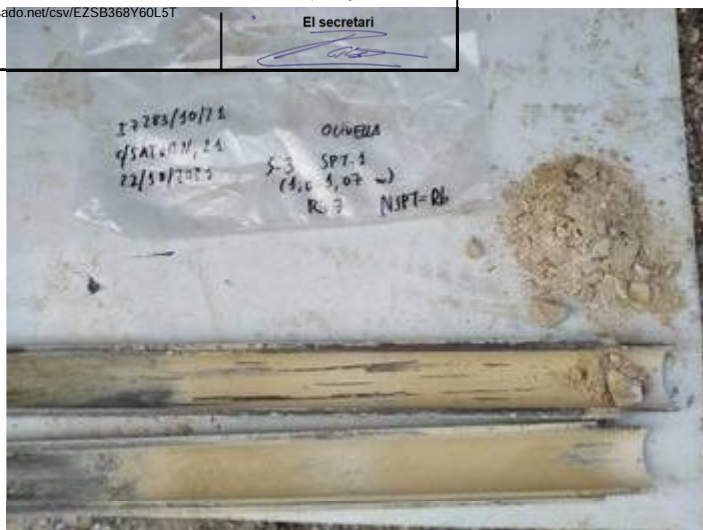
Vistes dels materials del subsòl extrets en un dels dos assaigs SPT realitzats al llarg del sondeig S-3.
