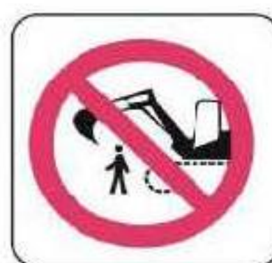
SP-220 PROHIBIT CIRCULAR O ROMANDRE AL RÀDIO D'ACCIÓ DE L'EXCAVADORA
