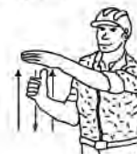
4 Levantar el aguilón o pluma lentamente.
