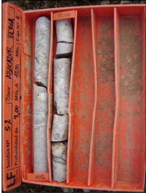
CAIXA N°4. DE 9,00 A 10,00 m. FI DE SONDEIG
