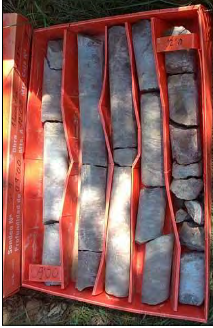
CAIXA N°4. DE 9,00 A 12,00 m. FI DE SONDEIG
