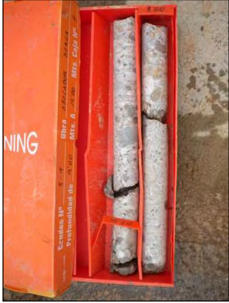
CAIXA N°4. DE 9,00 A 10,20 m. FI DE SONDEIG
