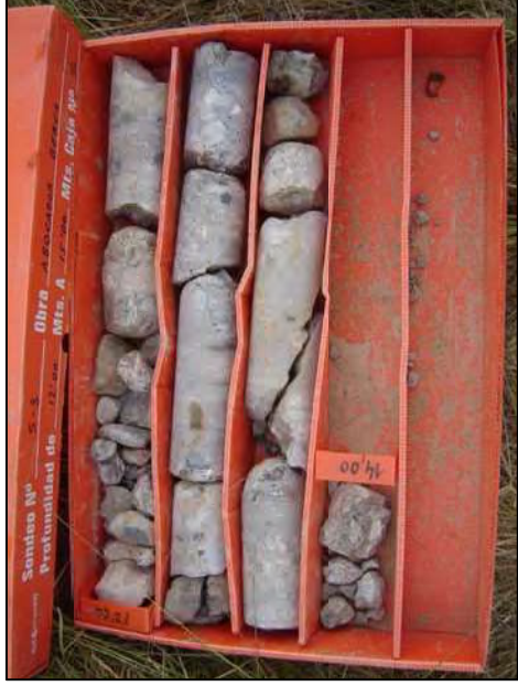
CAIXA N°5. DE 12,00 A 14,00 m. FI DE SONDEIG
