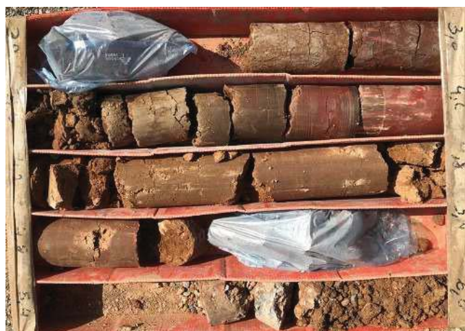
Fotografia 3: Caixa de testimonis S-1. C-2 (3,0 - 6,0 m).
