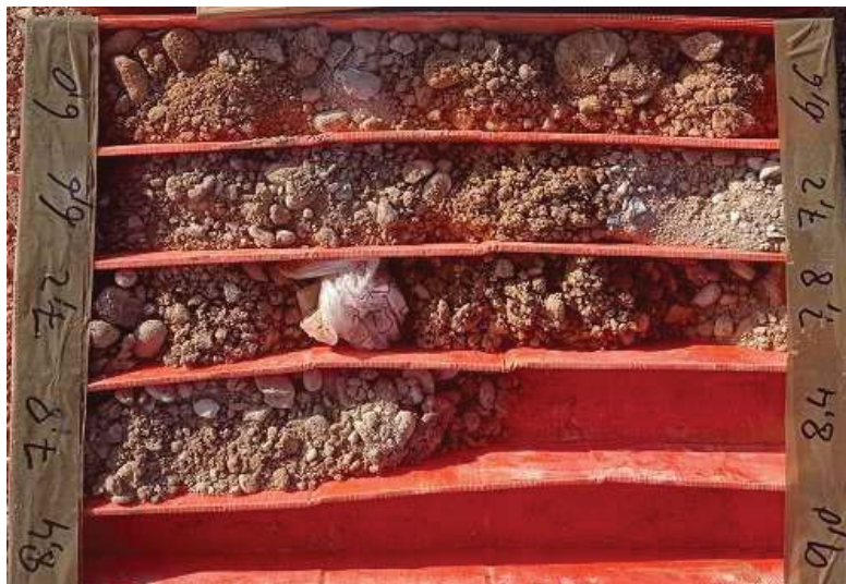
Fotografia 4: Caixa de testimonis S-1. C-3 (6,0 - 8,0 m).
