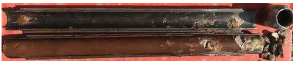
Fotografia 7: Assaig S.P.T.-3 (5,0 - 5,6 m)
