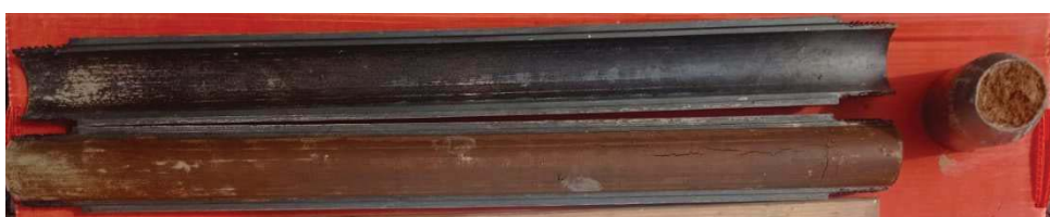
Fotografia 6: Assaig S.P.T.-2 (3,0 - 3,6 m)
