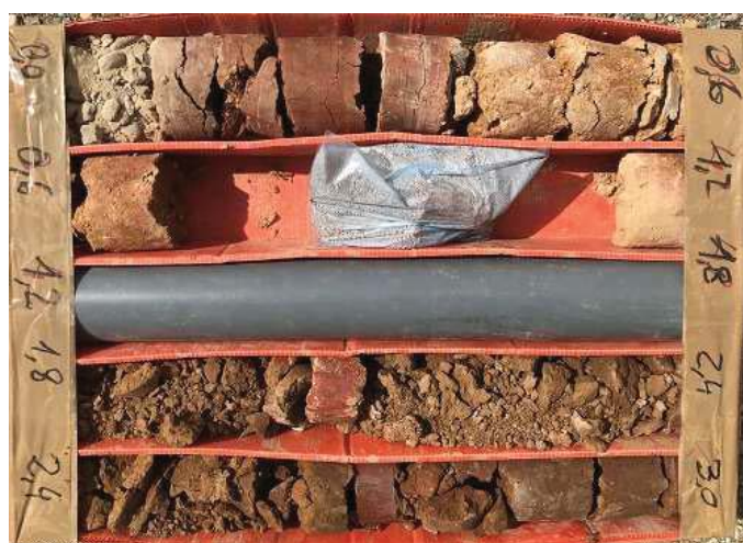
Fotografia 2: Caixa de testimonis S-1. C-1 (0,0 - 3,0 m).
