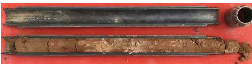
Fotografia 5: Assaig S.P.T.-1 (0,6 - 1,2 m)
