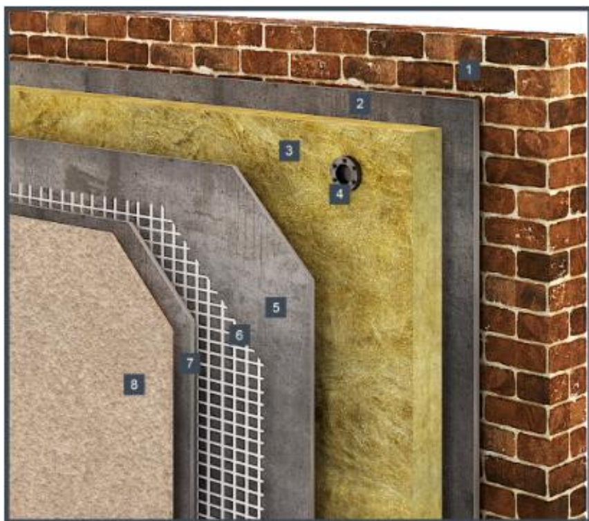
Il·lustració 3: Diferents capes que componen el SATE
