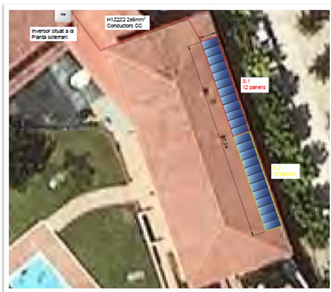
Il·lustració 11: Ubicació de les instal·lacions generadores sobre la coberta
