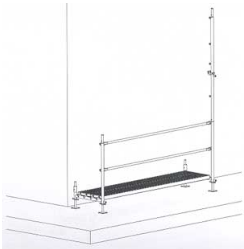
Figura 6 Instalación del marco parcial en L
