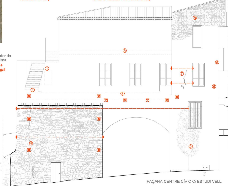
② Fissura vertical de l'arrebossat estucat de morter de calç Rejuntat de fissura i sanejament de l'arrebossat i tornar a realitzar l'estucat a la calç
