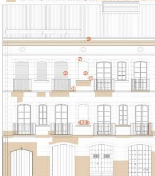
① Descrostant parcial de les pedres de la façana Consolidació per injecció de morter de calç i claus de lligat d'acer inoxidable
