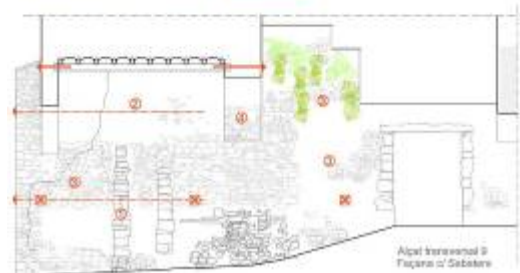
⑩ Humitats i descobriments parcial de l'arrebossat estucat de morter de calç Sanejament de l'arrebossat i les humitats i tornar a realitzar l'estucat a la calç
