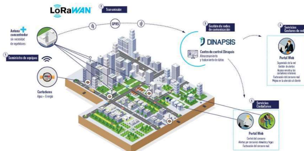
Esquema de funcionament del sistema LoRaWAN.
