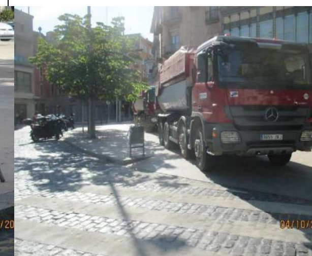
Fotografia 10: Prova de càrrega al carrer La Rambla sobre la riera de Galligans durant la fase 3
