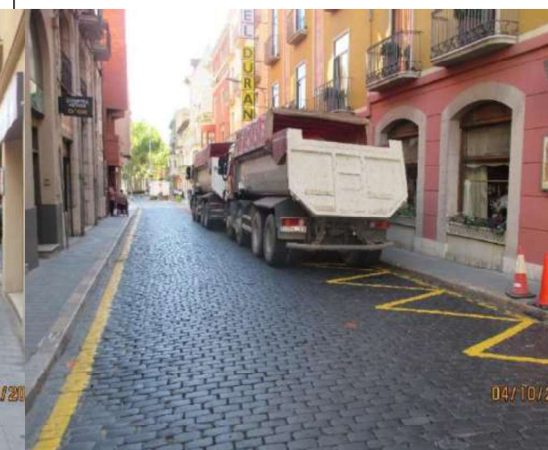
Fotografia 8: Prova de càrrega al carrer Lasauca, sobre la riera de Galligans durant la fase 2
