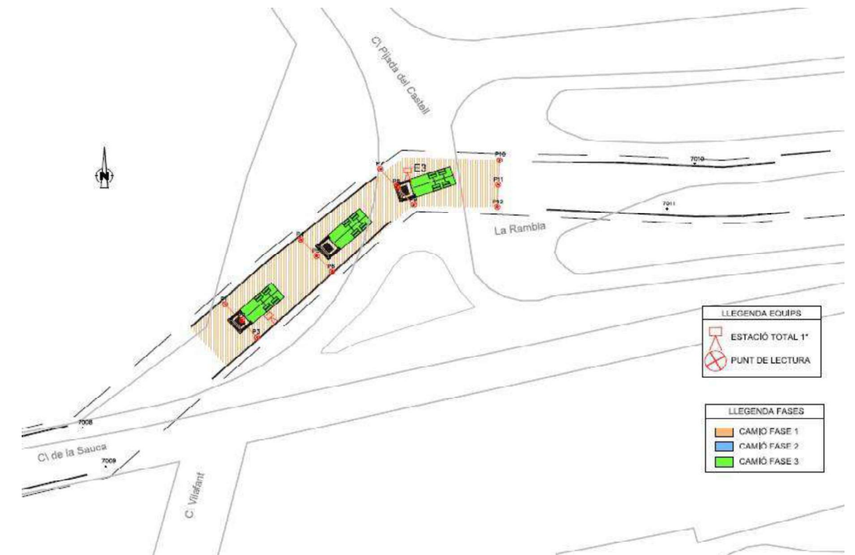
Figura 14.- Distribució de prisms d'auscultació, bases de referència i estacionament de la prova de càrrega 3.
