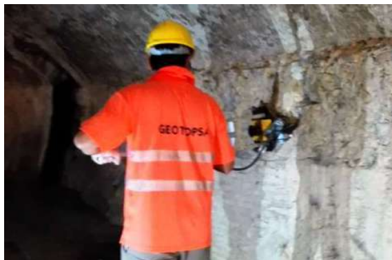
Antena HF de 1200 MHz
