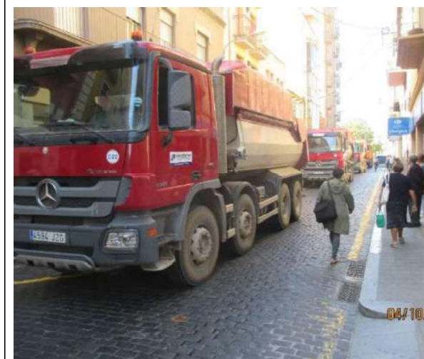
Fotografia 7: Prova de càrrega al carrer Lasauca, sobre la riera de Galligans durant la fase 1 de càrrega
