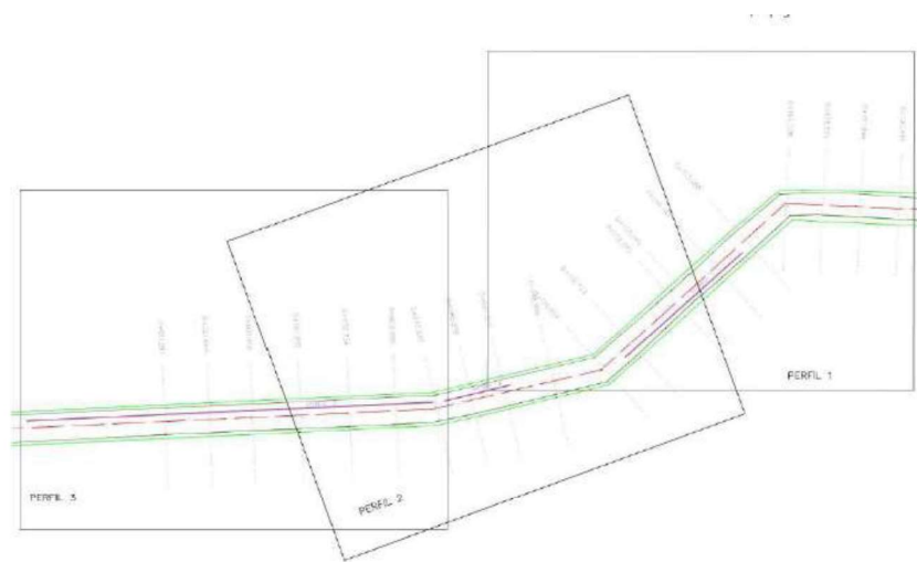
Figura 8 Perfils de la tomografia elèctrica
