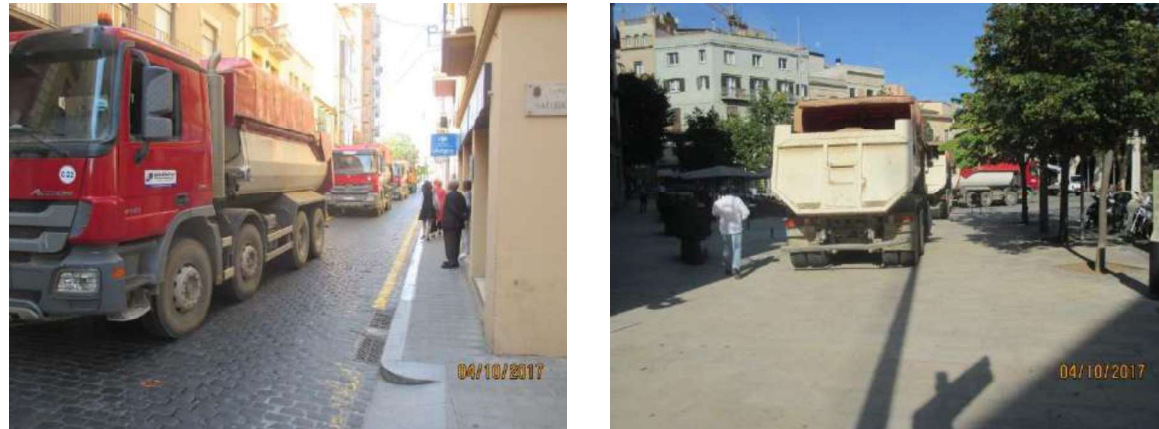
Figura 19.- Lectura amb tota la càrrega sobre l'estructura.
