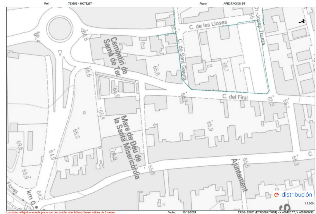
Figura 29. Plànol xarxa de baixa tensió existent – ACEFAT.
