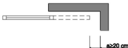
Figura 2.1 Holgura para evitar atrapamientos
