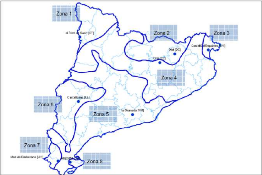
Figura 2: Zonificació per al càlcul de dipòsits de pluvials i pluviòmetres característics
