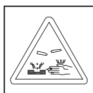
RIESGO DE CORROSION SUSTANCIAS CORROSIVAS
