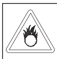
¡PELIGRO! MATERIAL COMBURENTE
